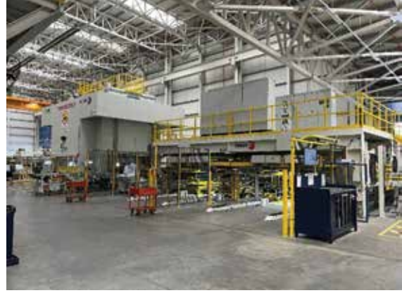
Şekil 2: Türkiye'de ilk ve tek 3600 ton transfer 1200 ton kesme presleri hattı
