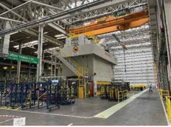
Şekil 2: Türkiye'de ilk ve tek 3600 ton transfer 1200 ton kesme presleri hattı
